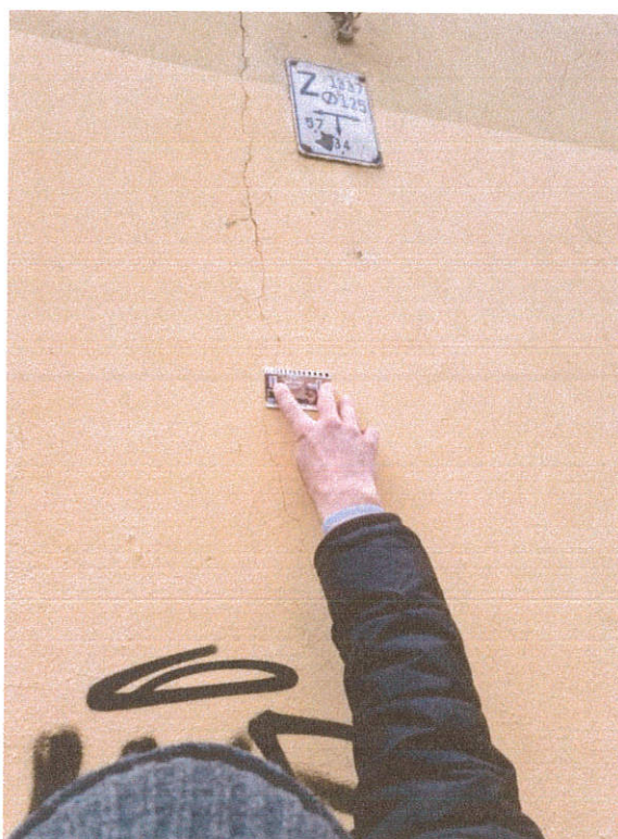
Fot. 21 - 22 Pomiary rozwartości rys na elewacji od ul. Eugeniusza Gepperta (dawniej Karola Szajnochy)
