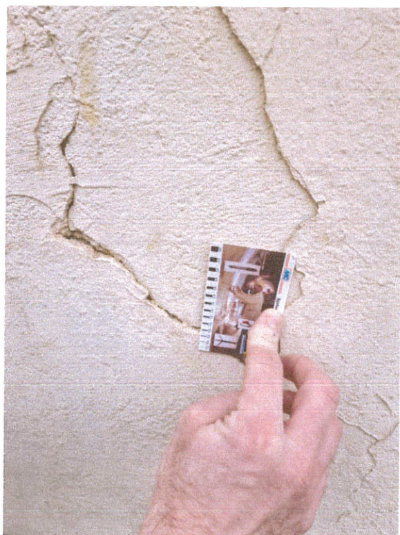
Fot. 21 - 22 Pomiary rozwartości rys na elewacji od ul. Eugeniusza Gepperta (dawniej Karola Szajnochy)
